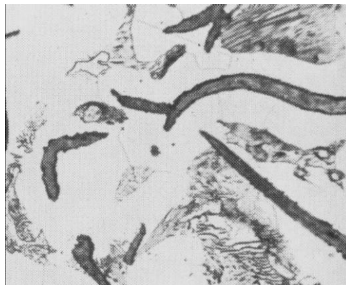
Slika 25: Unutrašnja struktura sivog lijeva s grafitnim listićima
