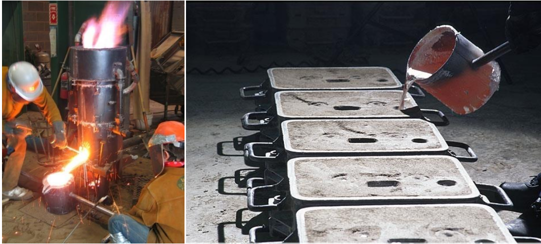
Slika 23. Kupolna peć za lijevanje željeza Slika 24. Lijevanje rastaljenog metala u kalupe
